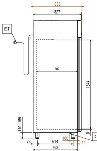
ED = Conexión eléctrica remota      RO = Salida de Refrigerante
